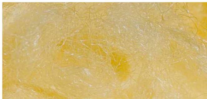
Диаметр волокна: 10 микрон Площадь поверхности: 1000 см²/г
