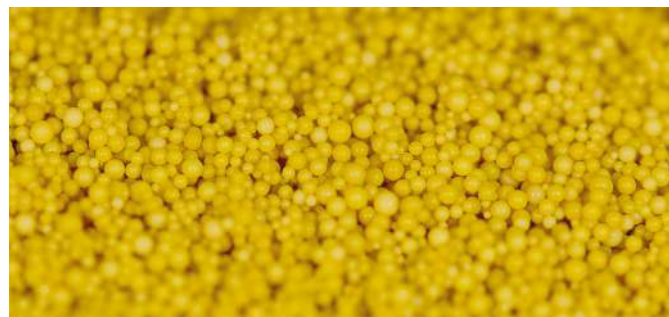
Диаметр гранулы: 700 микрон Площадь поверхности: 10 см²/г
